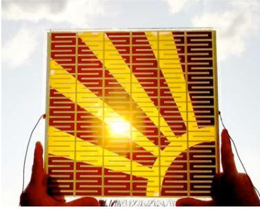
Durch Nanosolarzellen im Autolack, die im Unterschied zu herkömmlichen Solarzellen aus hauchdünnen lichtsammelnden Schichten bestehen, kann die Sonne die auf ein geparktes Auto scheint, dieses bei abgeschaltetem Motor dauerhaft mit Strom versorgen. Fällt auf diese Sonnenlicht werden Elektronen freigesetzt, die sich durch den umgebenden Elektrolyt bewegen und an einer Elektrode gesammelt werden. Dort werden sie dann als nutzbarer Strom weitergeleitet.
